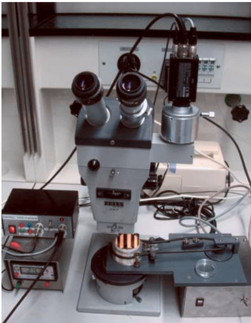
3. Imagen de un minicarrusel con rayas. Mediante este aparato las larvas del pez cebra ponen de manifiesto su capacidad visual.
