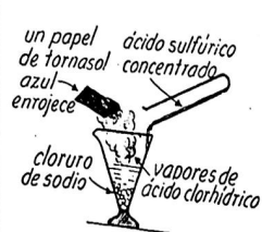
Fig. 59.—El ácido sulfúrico concentrado obrando sobre el cloruro de sodio produce ácido clorhídrico.
