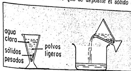
Fig. 5.—Decantación de agua turbia.
