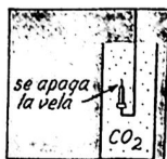
Fig. 42.—El \text{CO}_2 no permite la combustión.
