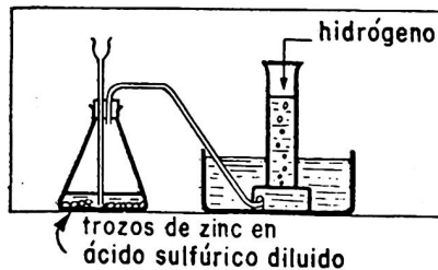
Fig. 28.—Obtención del hidrógeno en el laboratorio escolar.
