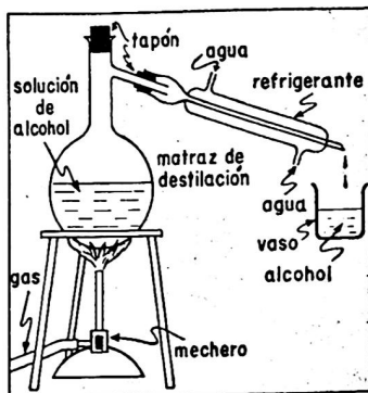
Fig. 106.—Obtención del alcohol etílico.
