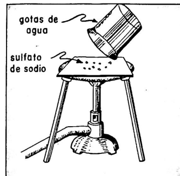
Fig. 37.—Los cristales de sulfato de sodio contienen agua.
