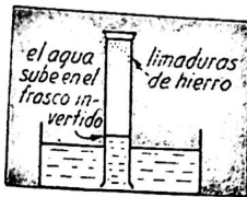
Fig. 44.—El hierro se oxida con el oxígeno del aire.
