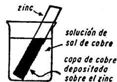
Fig. 51.—El zinc desaloja el cobre de una solución de sal de cobre.
