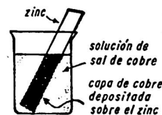
Fig. 98.—El cinc desaloja al cobre de una solución que contiene iones de cobre.
