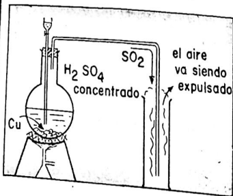
Fig. 69.—Preparación del \text{SO}_2 en el laboratorio.
