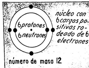
Fig. 4.—Estructura de un átomo de carbono.
