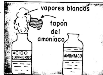
Fig. 75.—Para reconocer el ácido clorhídrico y el amoníaco, se acercan sus vapores y se forma una niebla blanca muy espesa.
